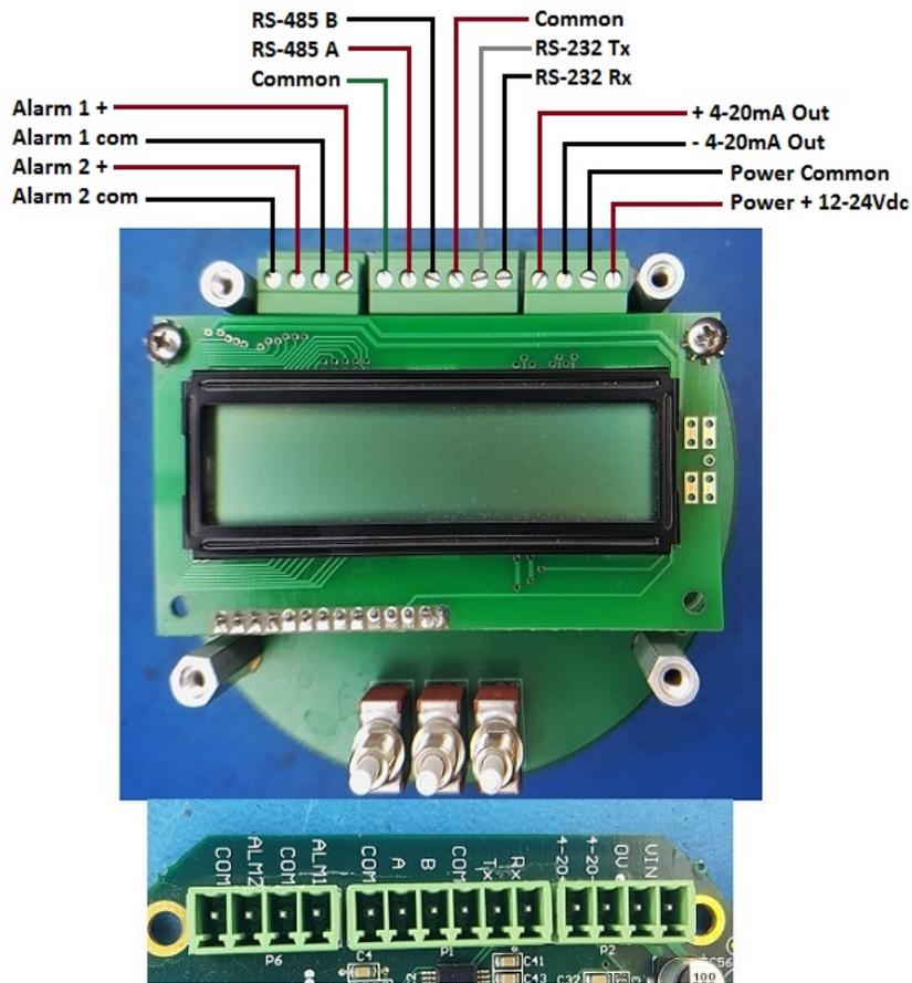
Figure F-12: Alarm wiring
