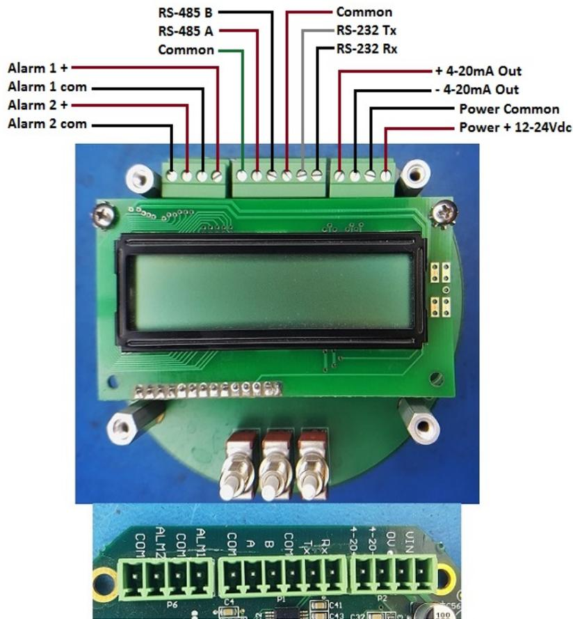
Figure F-12: Alarm wiring
